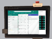
softTP Tablet Roboter- Bediengerät
