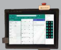
softTP Tablet Roboter- Bediengerät
